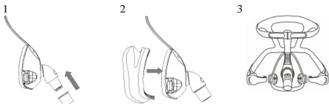
1 将弯管接头安装在弯管上，并确定安装后弯管接头转动顺畅。
